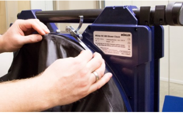
Abb. 11: Spannband um Ventilatorrand verschließen
