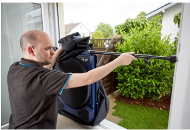
Abb. 13: Einspannen der Teleskopstange in den Fensterausschnitt
