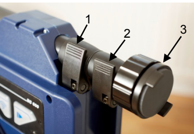
Abb. 14: Detailaufnahme Teleskopstange mit Klemmen (1) und (2) sowie Kopf (3)
