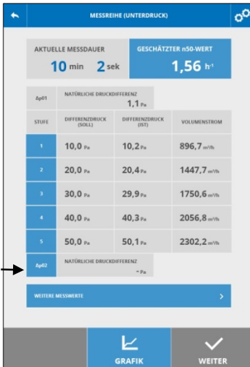
Abb. 53: Messung der natürlichen Druckdifferenz, Startfeld mit Pfeil markiert
