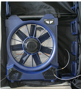
Abb. 20: Ventilatoreinheit mit Netzkabel und Kapillarschläuchen
