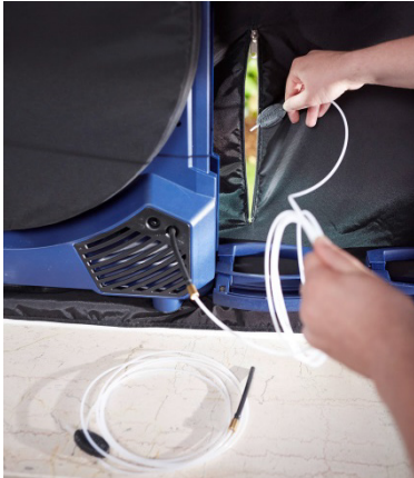
Abb. 19: Der Kapillarschlauch wird durch die Folie nach außen geführt
