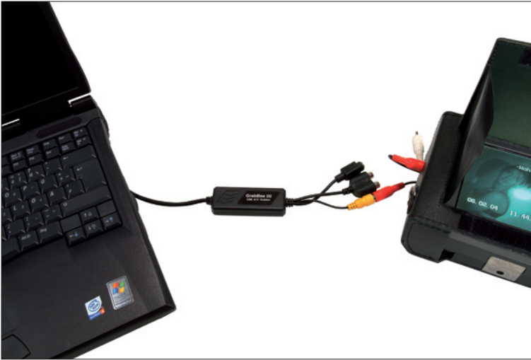
Abb. 2.1: Anschluss des GrabBee X+ deluxe an den PC und an den Monitor VIS 2000 PRO
