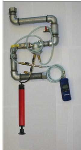
Bild 6.2: Anschlussbild zur Bestimmung des Leitungsvolumens  $V_{\text{Rohr}}$  links mit medizinischer 100 ml Spritze, rechts mit Handrußpumpe
