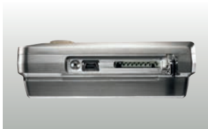
Seitlicher Anschluss von Mini-USB-Kabel und SD-Karte
