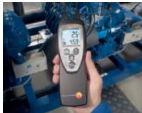
Gleichzeitige Messung der Überhitzung und Unterkühlung an Kälteanlagen mit testo 922
