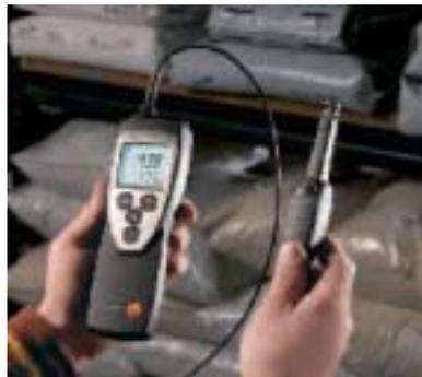
Feuchte-Fühlerkopf über Handgriff mit Fühlerleitung, z.B. zur Kontrolle des Lagerklimas
