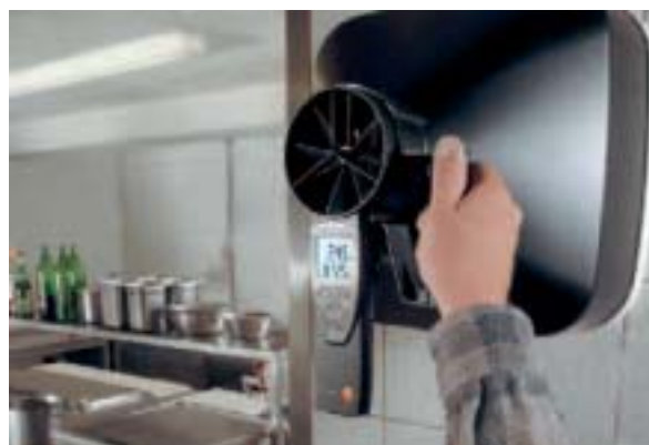
testo 417, z.B. zur Kontrolle der Abluft an einem Aufputzlüfter
