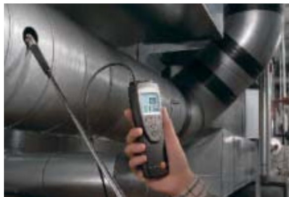
testo 416, z.B. zur Bestimmung des Volumestroms der Abluft
