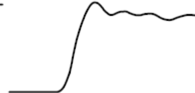
Signal mit einem langen Erdungsleiter
