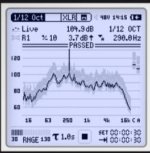
Die "Spektrale Grenzwerte" Option erweitert die Spektralanalyse mit einer Auflösung von 1/6 und 1/12 Oktave, einer Zoom-FFT, der Aufnahme von Referenz-kurven, einer relativen Anzeige und einem umfangreichen Toleranz-management. Der XL2 Analysator vergleicht das Spektrum mit einer Referenzkurve oder einem Toleranzband für ein Gut/Schlecht-Messergebnis.
