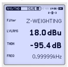
Mit dem symmetrischen XLR- und unsymmetrischem Cinch-Eingang bildet der XL2 einen hochwertigen Audio-Analysator. Er misst simultan Effektivwertpegel, Frequenz und Klirrfaktor (THD+N).
