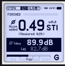
Der XL2 Analysator misst die Sprachverständlichkeit von Evakuierungsanlagen und Durchsagesystemen nach IEC 60268-16 mit interner Umgebungslärmkorrektur und automatischer Mittelung.
