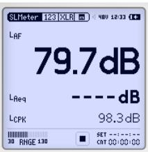
Der XL2 bildet zusammen mit dem Messmikrofon einen präzisen Schallpegelmesser für die Veranstaltungsüberwachung sowie für die Messung von Umgebungsoder Arbeitsplatzlärm. Alle Messergebnisse stehen gleichzeitig zur Verfügung, wie z.B. der aktuelle Schallpegel, Lmin, Lmax, Leq, LCpeak mit den Frequenzgewichtungen A, C, Z und den Zeitbewertungen Fast, Slow und optional Impuls.
