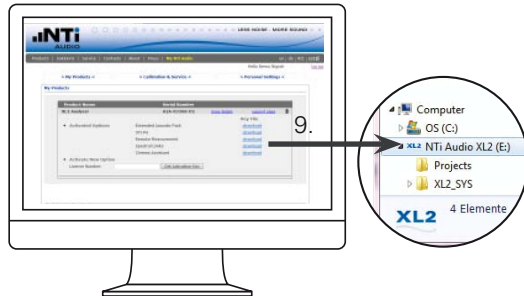
Aktivierungsdatei herunterladen und auf den XL2 kopieren (xx_0xxxx.txt)
