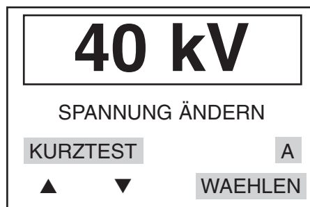
Abbildung 14 Bildschirmbeispiel: Einstellung der Spannung für einen Überlastversuch
