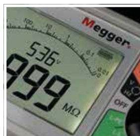
Analogbogenanzeige mit Hintergrundbeleuchtung
