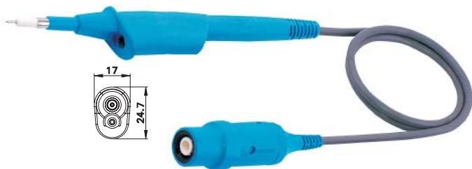
Sicherheits-Hochfrequenz-Tastkopf 100:1 für die sichere Erfassung hoher Spannungen. Hoch flexible, PVC-isolierte koaxiale Anschlussleitung mit BNC-Stecker mit integrierter Kompen-sationseinheit. Ø 2 mm-Sicherheitsbuchse für Referenzanschluss im Griffteil des Tastkopfes. Durch geringe Eingangskapazität und grossen Eingangswiderstand ist dieser Tastkopf auch besonders geeignet für Messungen an empfindlichen Schaltkreisen.
