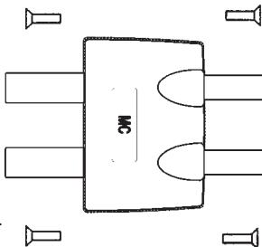
Bei Typ **XKH-4/19/D** die beiden Verschlussstopfen in die frei gebliebenen Öffnungen drücken.
