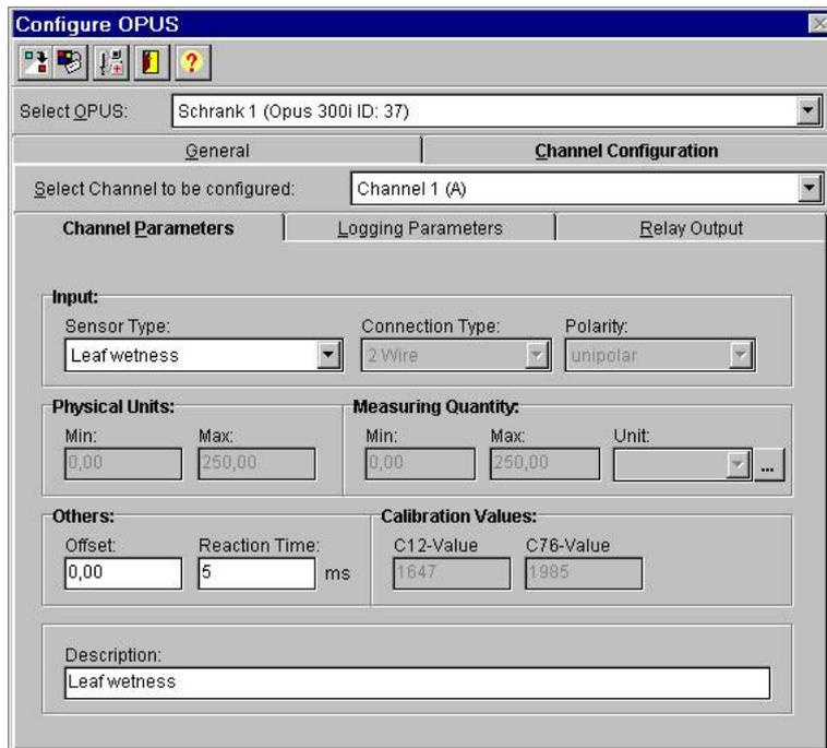
Bild: Kanalkonfiguration in SmartControl
