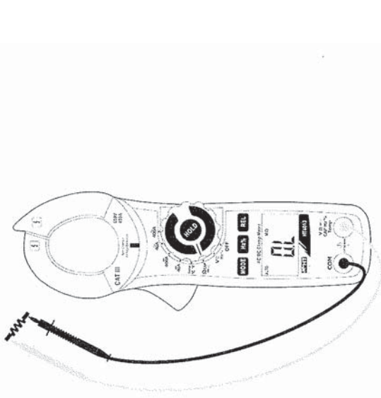
Fig. 5: Uso de la pinza para medida de Resistencia
