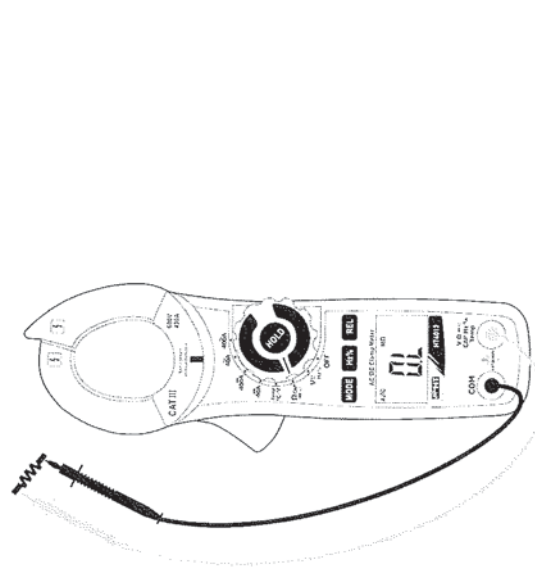
Abb. 5: Verwendung der Zange für Widerstandsmessung
