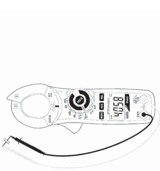
Fig. 6: Uso de la pinza para medida de Capacidades
