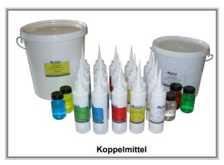
Zur Ankopplung der Ultraschalltechnik-Prüfköpfe an die Prüfgegenstandoberfläche werden spezielle Koppelmittel eingesetzt. Diese sollen verhindern, dass sich ein Luftspalt zwischen Prüfkopf und Prüfobjekt bildet, welcher den Durchgang der Schallimpulse stören würde.
