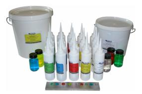
Koppelmittel dienen zur Ankopplung der Kontakttechnik-Prüfköpfe an die Oberfläche der Prüfgegenstände. Dies ist nötig, um den Luftspalt zwischen Prüfkopf und Prüfobjekt zu beseitigen, der den Durchgang der Schallimpulse verhindern würde. Prinzipiell sind alle Flüssigkeiten und Pasten als Koppelmittel verwendbar, doch haben sich spezielle Mittel als besonders vorteilhaft erwiesen.
