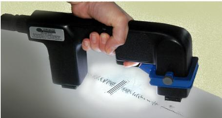
Die spritzgeschützten (IP 65) Leuchtelemente sind für alle Jochmagnete mit Fußabmessungen unter 50x50 mm einsetzbar. Die schnell und einfach aufsetzbaren Leuchtelemente werden am Fuß des Jochmagnetes mittels zweier Kunststoffschrauben befestigt.
