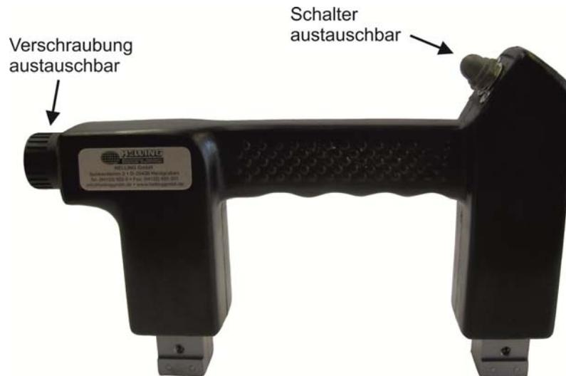
Zu den wesentlichen Vorteilen des Jochmagneten **UM-8-230** gehört die Wicklungsanordnung direkt an den Polen. Hierdurch wird eine hohe Feldstärke erreicht. Für ein ermüdungsfreies Arbeiten sorgen der schmale Griffsteg und das geringe Gewicht. Die Oberfläche des Handgerätes ist leicht angeraut, um das Verrutschen in der Hand zu vermeiden.
