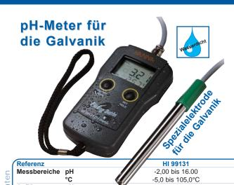
Plattier-Bäder sind in der Regel sehr agressiv und können herkömmliche pH-Elektroden stark beschädigen. HI 99131 wird mit einer Titan-Elektrode geliefert, die speziell für Anwendungen in der Galvanik entwickelt wurde: mit flachem Kontaktsensor und ringförmigem PTFE (Polytetrafluorethylen)-Diaphragma, welches ein Festsetzen gelöster Feststoffe vermeidet.
