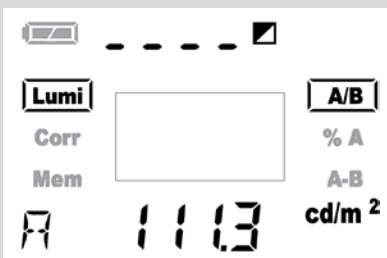
Displayanzeige einer Leuchtdichtemessung
