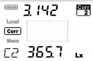
Displayanzeige der Luxmessung mit Reflexionsstandard
