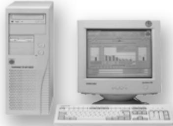
**HYDROMAT GA-TKMP40**, Zentral Computer zur Steuerung von bis zu 32 Trockenkammern. Die Anlage besteht aus dem Zentral-Computer GA-MPC-40 einem Farbmonitor, Tastatur zur Eingabe, Speicherung und Anzeige aller Trocknungsdaten, sowie einem Peripheriecomputer GA-MPP5 für jeden angeschlossenen Trockner. Die Peripherie Computer GA-MPP5 regeln nach Eingabe der Trocknungsparameter völlig unabhängig die Trocknung in den zugeordneten Trockenkammern.
