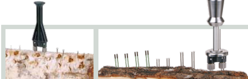
ANWENDUNG Verschiedene Nagellängen im Überblick: Einsatz mit den Elektroden M 20 [links] und M 18 [rechts]
