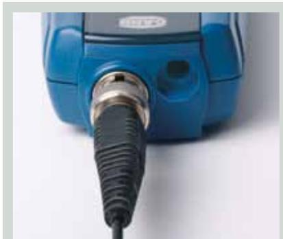
**DETAILANSICHT** Neben einem **BNC-Anschluss** verfügt die **BL HT 70** noch über einen **Klinkensteckeranschluss**, an den verschiedene **Temperatursensoren** angeschlossen werden können
