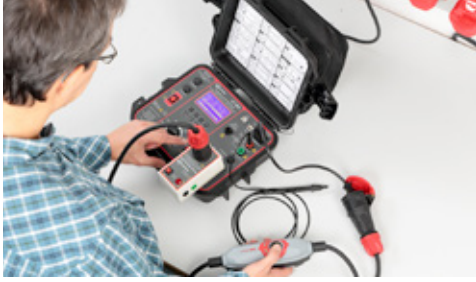
Prüfung von ortsveränderlichen Fehlerstrom-Schutzschaltern (PRCD, PRCD-S, PRCD-S+, PRCD-K) (nur GT-900).
