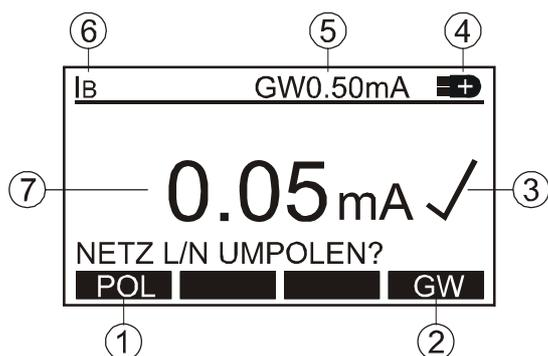
Abb. 20: LC-Anzeige bei der Berührungstrommessung I<sub>B</sub>
