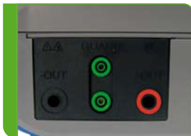
Das Anschlussfeld zum anschliessen der geschirmten Prüfleitungen.
