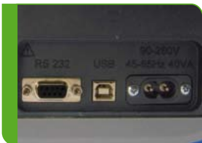
Kommunikation über USB- und RS232-Schnittstelle.
