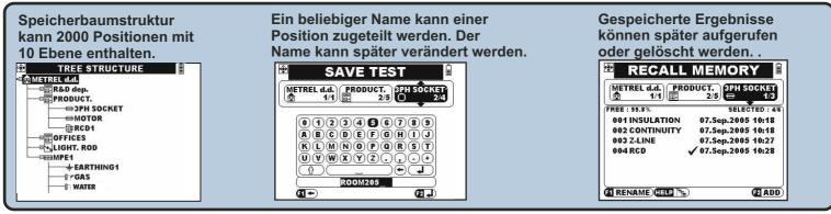
Nach der Übertragung der Messergebnisse, können standardisierte Testberichte mit wenig Aufwand erstellt werden.
