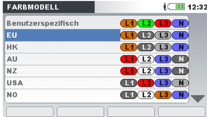
Abbildung 3.70: Farbdarstellungen der Phasenspannungen
