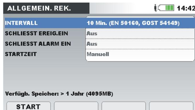
Abbildung 5.18: Vordefinierte Konfiguration des Rekorders nach EN 50160
