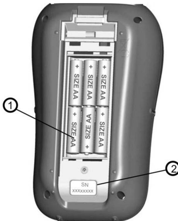
Abbildung 7.1: Batteriefach
