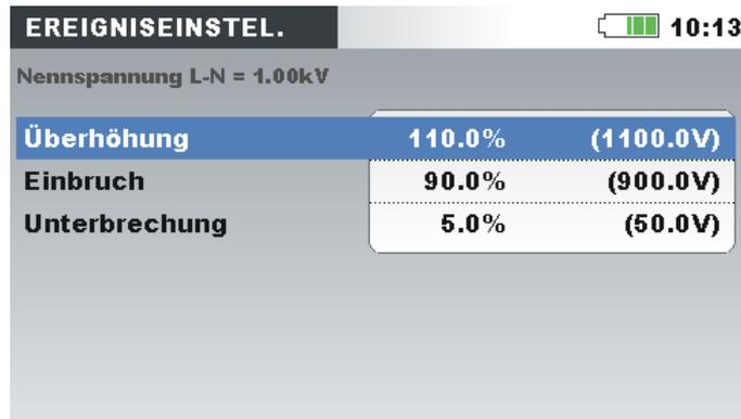
Abbildung 3.60: Bildschirm für die Ereigniseinrichtung
