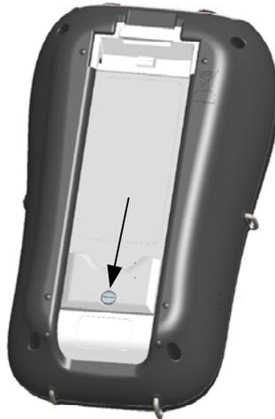
Abbildung 7.2: Schließen der Batteriefachabdeckung
