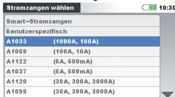
**Hinweis:** Für Smart-Stromzangen (A 1227, A 1281) wählen Sie immer „Smart-Stromzangen“ aus.
