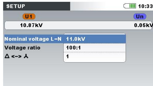
Abbildung 4.13: Beispiel für das Spannungsverhältnis eines 11 kV / 110 V-Wandlers
