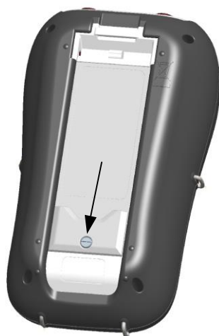
Abbildung 7.2: Schließen der Batteriefachabdeckung
