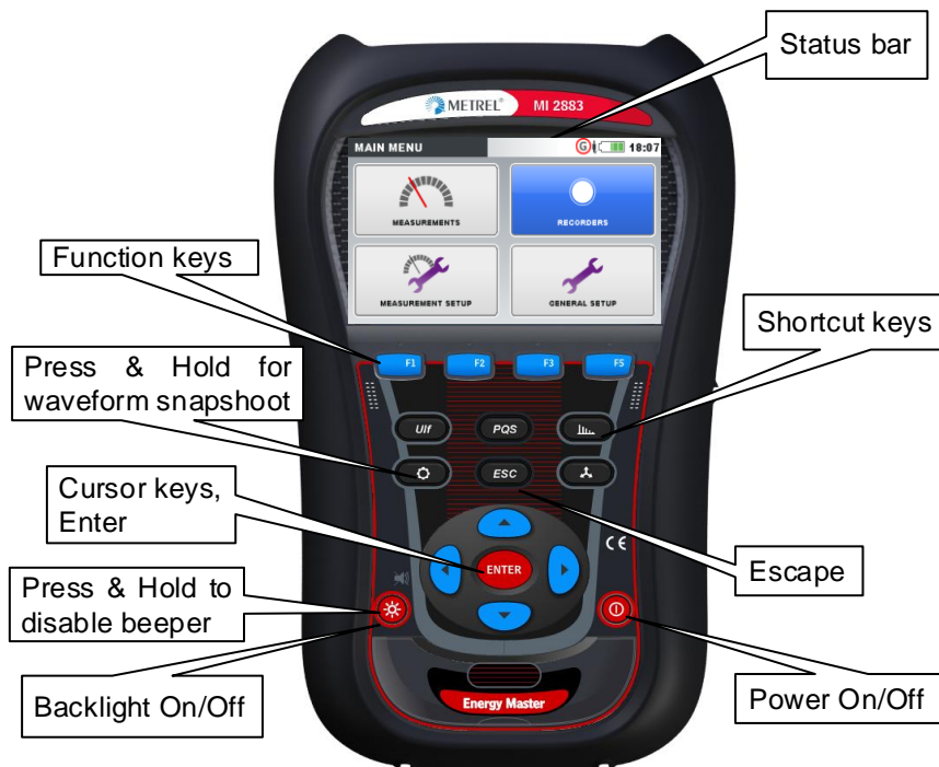
Abbildung 3.1: Beschreibung der Symbole auf dem Display und der Tasten
