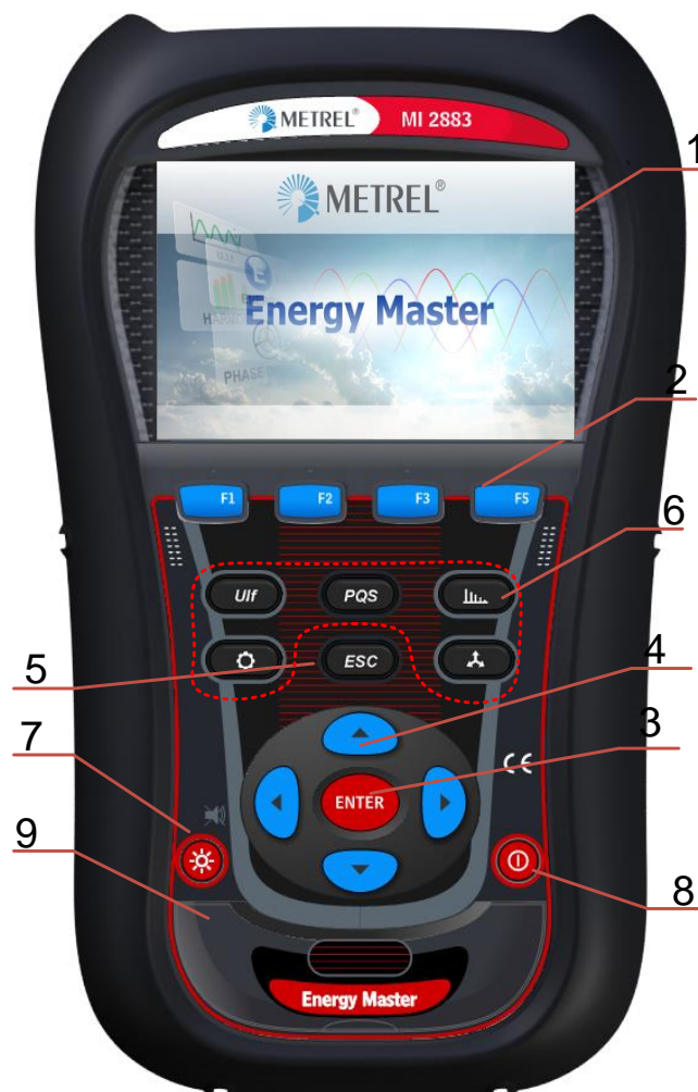
Abbildung 2.1: Bedienfeld auf der Vorderseite
