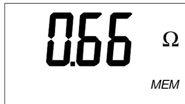
Gespeichertes Ergebnis ( $R_{\pm 200\text{mA}}$ )
