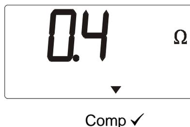
**Bild 9.** Ergebnis einer Durchgangsmessung. Die Prüfleitungen waren kompensiert.
