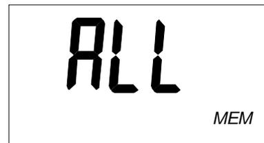
**Bild 14.** Anzeige zur Löschung des gesamten Speichers, muß mit **CLR** bestätigt werden
