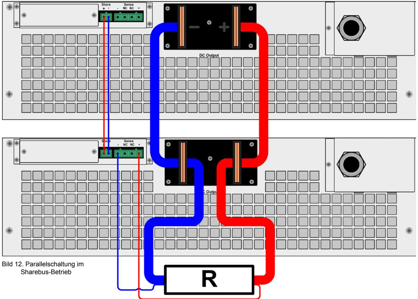
Bild 12. Parallelschaltung im Sharebus-Betrieb
