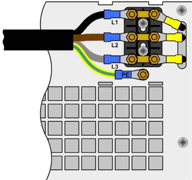
Bild 7. Netzanschluß 6.6kW/10kW/15kW
