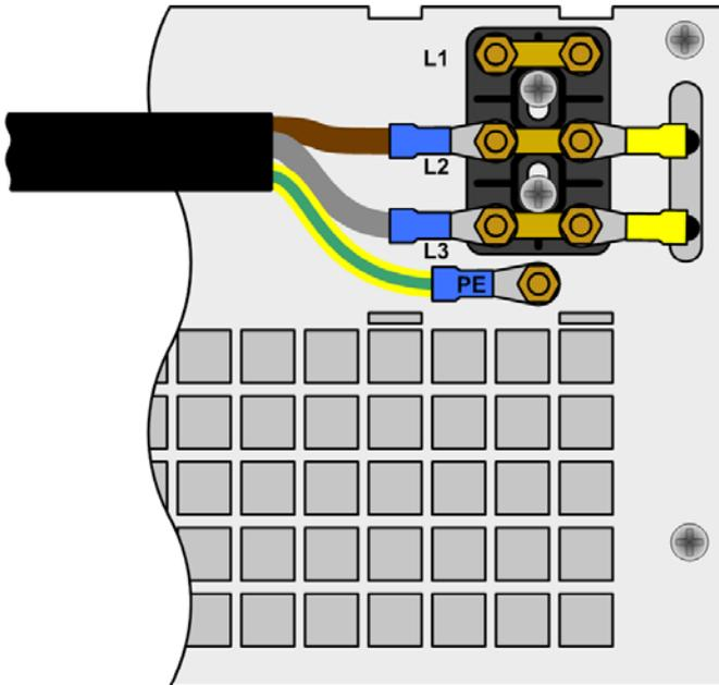
Bild 6. Netzanschluß 3.3kW/5kW
