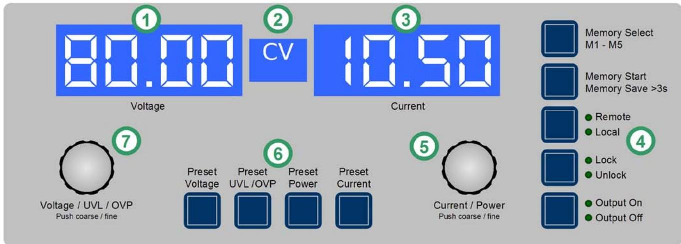
Bild 8. Bedieneinheit
