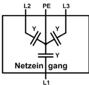
Beispieldarstellung aus der Norm, Bild C.3c, Schutzleiterstrommessung, Ersatzableitstrommeßverfahren:
