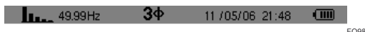
Abbildung 18: Das Zeichen 3\phi oben im Display steht für eine Anschlusskonfiguration im symmetrischen Dreiphasensystem.
