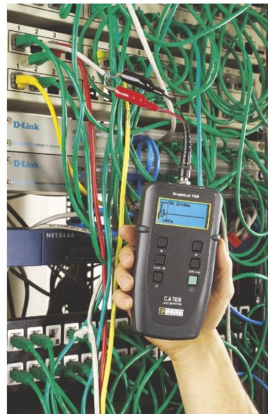
Prüfung von Telefonleitungen mit einem C.A 7026 an einer Verteilertafel
