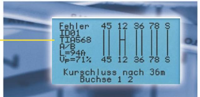
Beispiele von Identifikationsschemen von unterbrochenen und gekreuzten Paaren in den Kabeln
