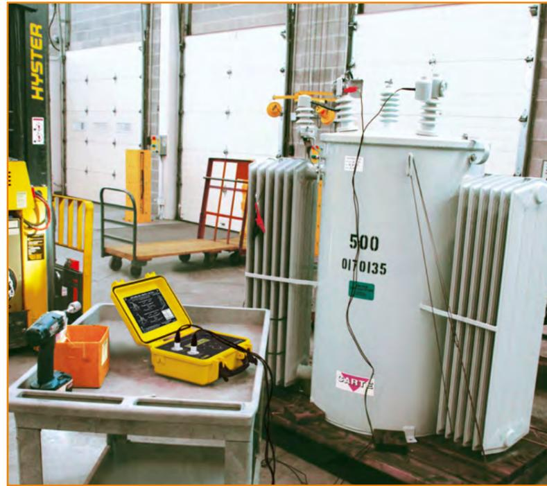
Der **DTR® 8510** ist ein tragbarer, digitaler Windungsverhältnis-Prüfer mit dem sich Leistungs-, Spannungs- und Stromwandler bequem und exakt prüfen lassen. Nach Anschluss an den stromlosen Transformator zeigt der **DTR® mit hoher Genauigkeit** das Windungszahlenverhältnis zwischen Primär- und Sekundärkreis an und gleichzeitig die Windungspolarität sowie den verwendeten Erregerstrom.
