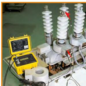
Messung des Wandlerverhältnisses an einem Stromwandler
