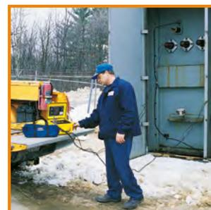
Vor-Ort-Prüfung eines 2000 kVA-Drehstromtransformators
