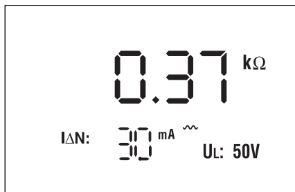
Affichage résistance de de la mise à terre
