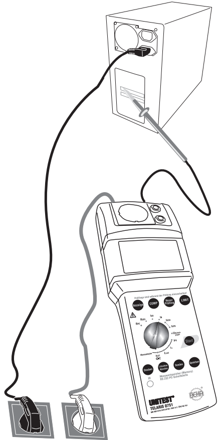
Bild 6.11: Messung des Berührungstromes
