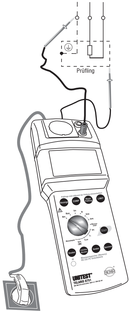
Bild 6.3: Messung des Schutzleiterwiderstandes bei Geräten ohne Netzstecker
