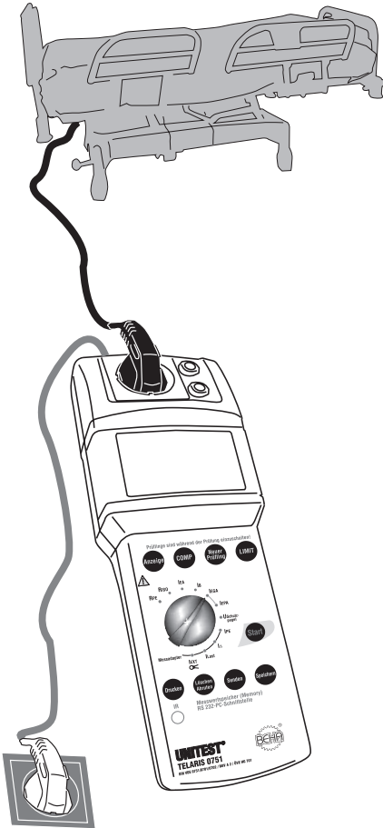
Bild 6.23: Messung des Ersatz-Geräteableitstromes bei Geräten der Schutzklasse I
