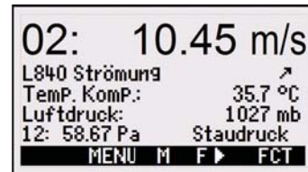
Strömungs-Anzeige, Messwert automatisch kompensiert mit Temperatur und Luftdruck
