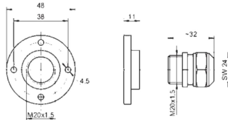
verschiebbare Messing - Verschraubung für Fühlerrohr  $\varnothing$  12 mm
